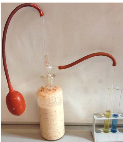
Figura 2. Sistema de reflujo para extracción de cianuro de macerados. Soluciones de Ninhidrina (Amarillo) y complejo de cobre-amoniaco (Azul)
