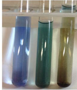
Figura 4. Solución complejo de cobre-amoniaco antes y después de ser expuesta por burbujeo 2 min (centro) y 10 min (derecha)
