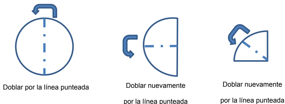
Figura 18 Procedimiento para el doblado correcto del papel filtro. Elaboración propia.
