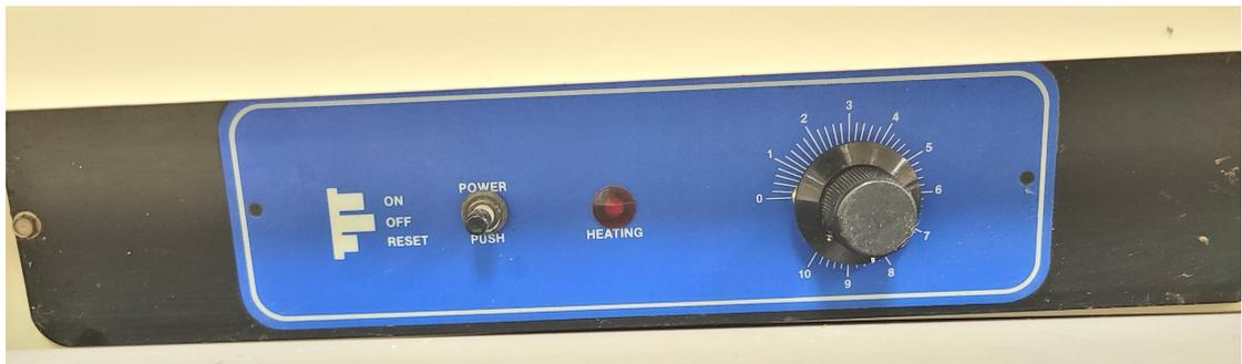
**Imagen 1.** Interruptor-piloto, sensor de temperatura, perilla de control de la temperatura.
